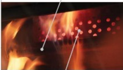
klapka bypass uzavřena; uvnitř topné komory vpředu nahore)
